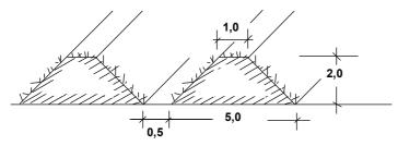
Höhe: max. 2,00 m Länge: unbegrenzt Breite: max. 5,00 m Querschnitt: trapezförmig
