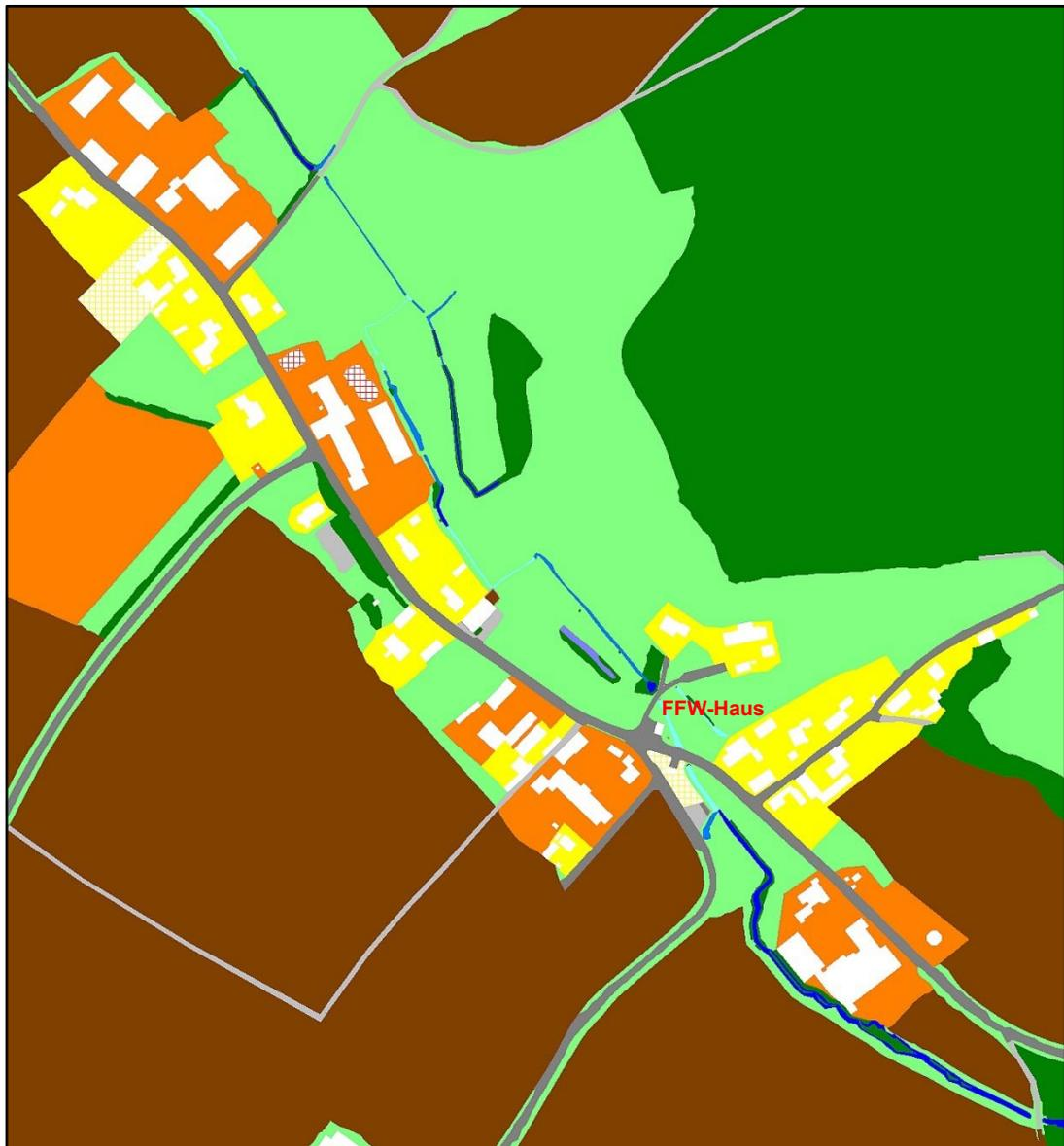
Abbildung 9: Berechnungsmodell mit Rauigkeitsbelegung
